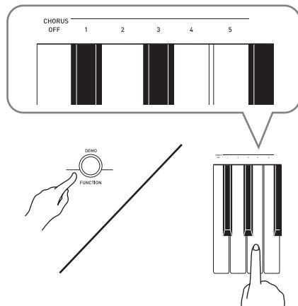
Имеется пять типов хоруса и вариант отключения эффекта.
