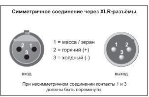
Рис. 3.1: XLR-соединения
