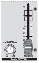
Рис. 2.10: Мониторный регулятор и фейдер Main Mix
